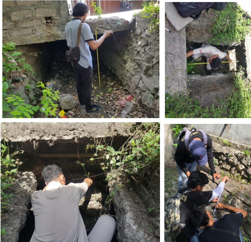
Gambar 3.2. Observasi dan Pengukuran Dimensi Saluran
